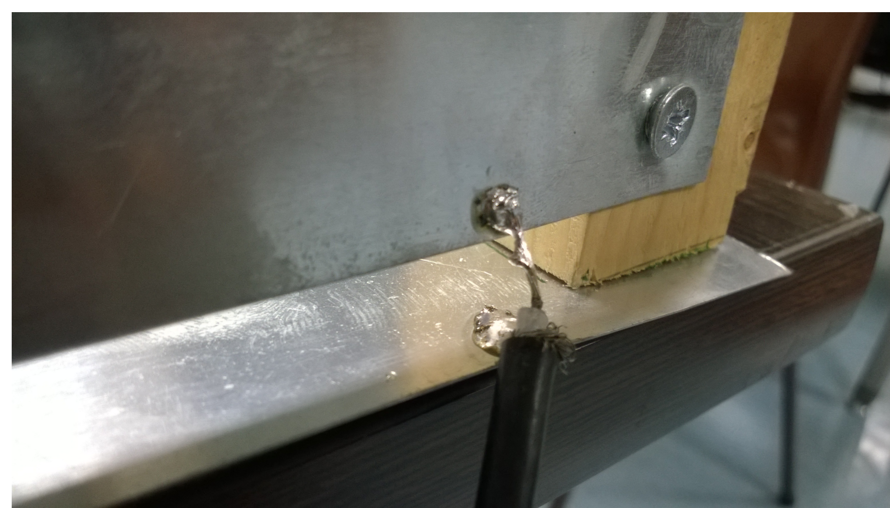
Figura 3: Pormenor da ligação a um cabo coaxial. O plano na vertical é uma das armaduras do condensador formado com a esfera metálica, o plano horizontal está ligado à massa.
